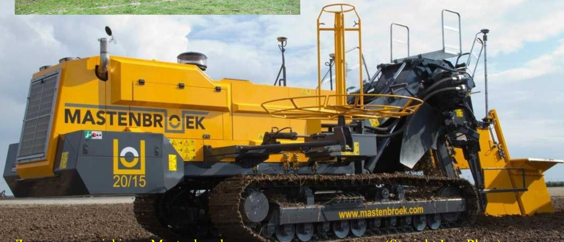
Дреноукладачі фірми Mastenbroek: з одним прямим ножем (Straight Leg Plow)
